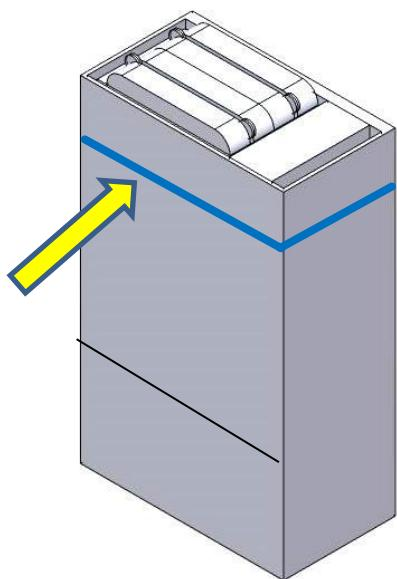
Befestigen Sie den Deckel mit einem Ratschenspanngurt
