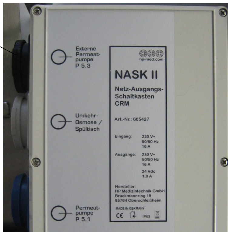
Abb. 12: Anstecken der Permeatpumpe am NASK II
