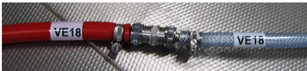
Abb. 18: Koppelung der Schläuche mit Doppelnippel Edelstahl R3/4
