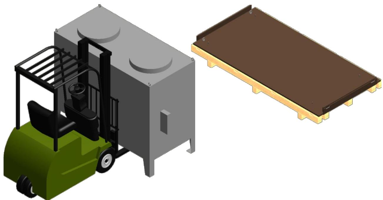
Den Prozesswasserkühler vorsichtig mit einem Gabelstapler oder mit einem Kran auf den Kistenboden stellen.
