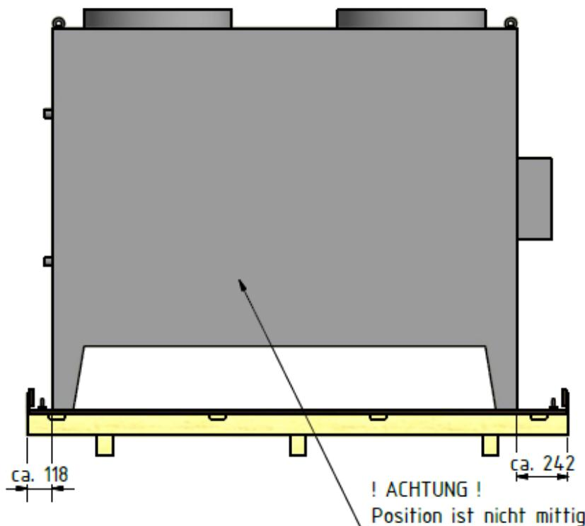
Auf Grund der seitlichen Einbauteile kann das Gerät nicht mittig in der Kiste positioniert werden.
